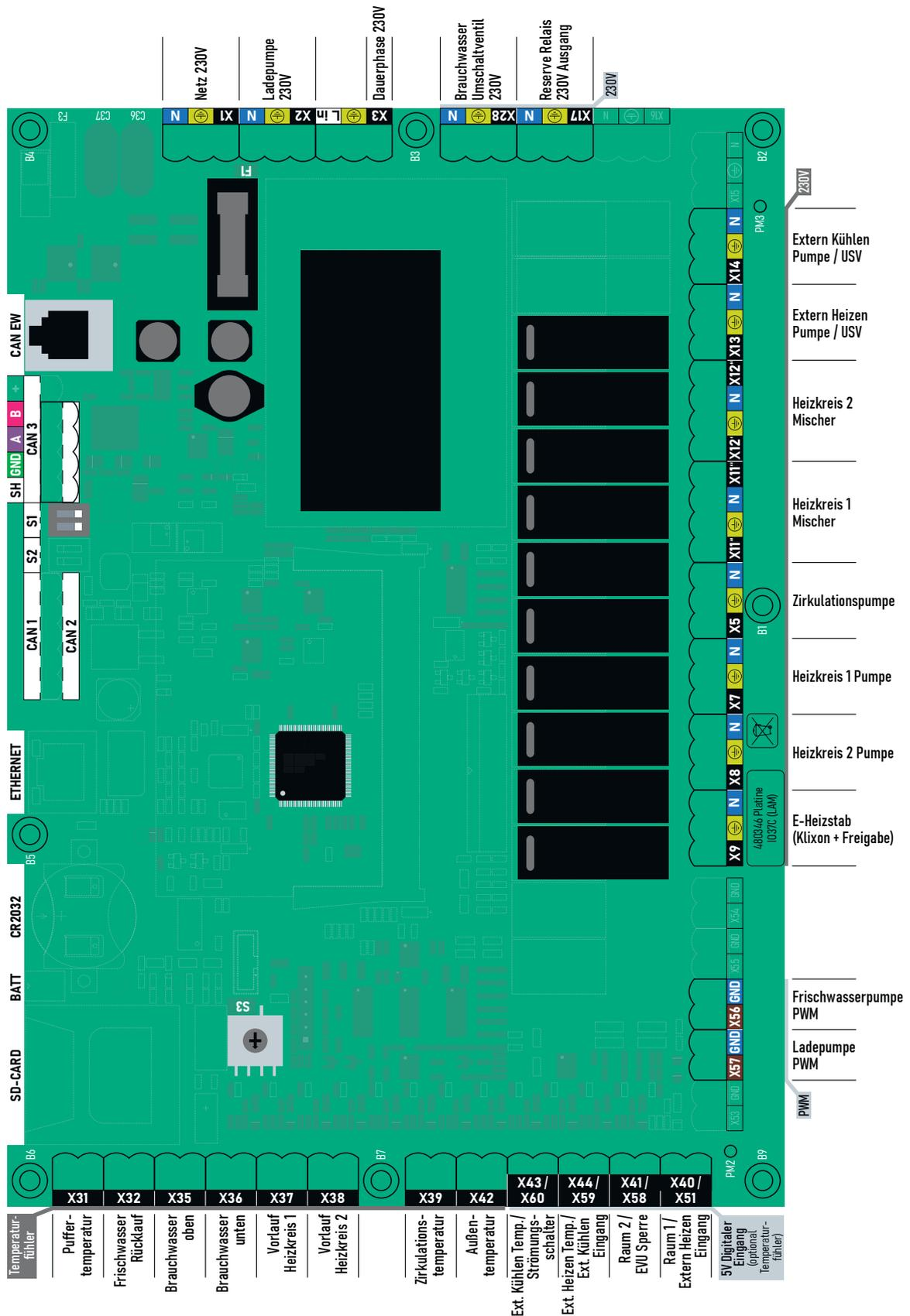
Abb. 3: Anschlussklemmen AHC Hydraulikregler
