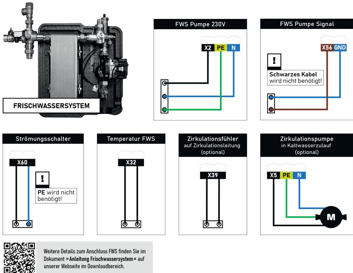
Abb. 7: Anschluss Frischwassersystem
