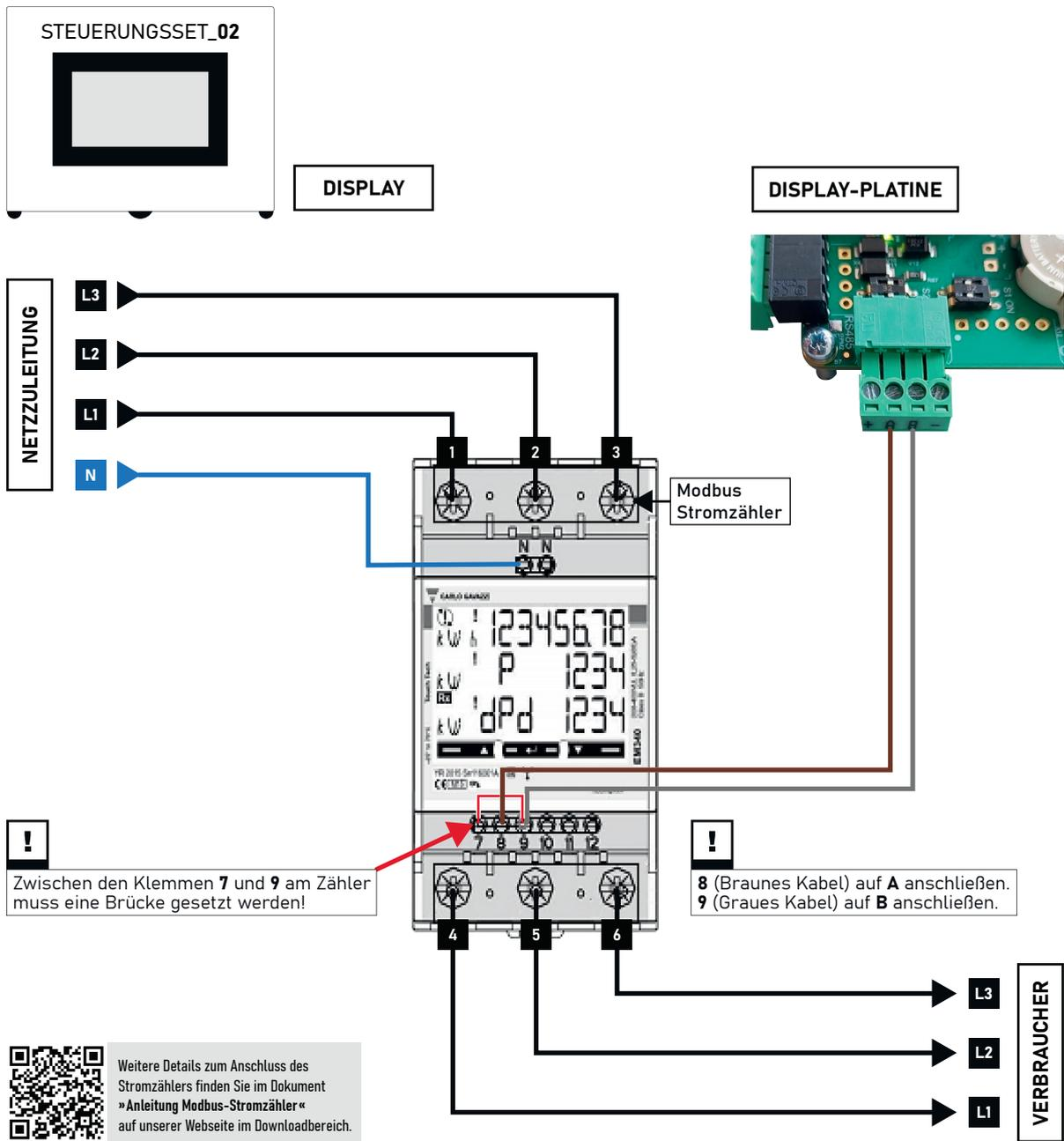
Abb. 8: Einbindung Smart Meter
