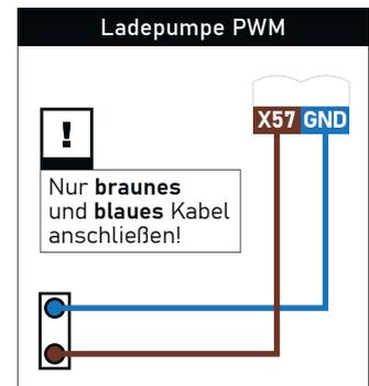
Abb. 5: Anschluss Hydraulikstation
