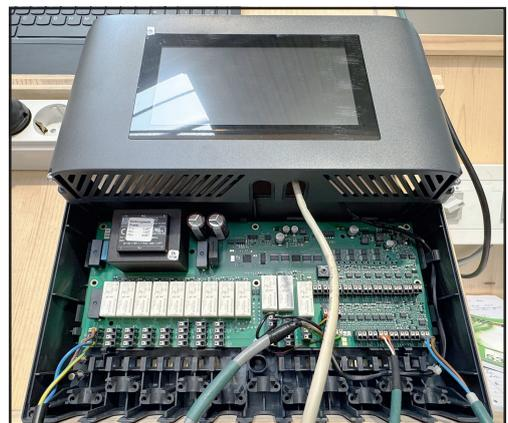
Deckel vom Regelgehäuse lässt sich für Kabelanschluss am oberen Rand einfach fixieren!
