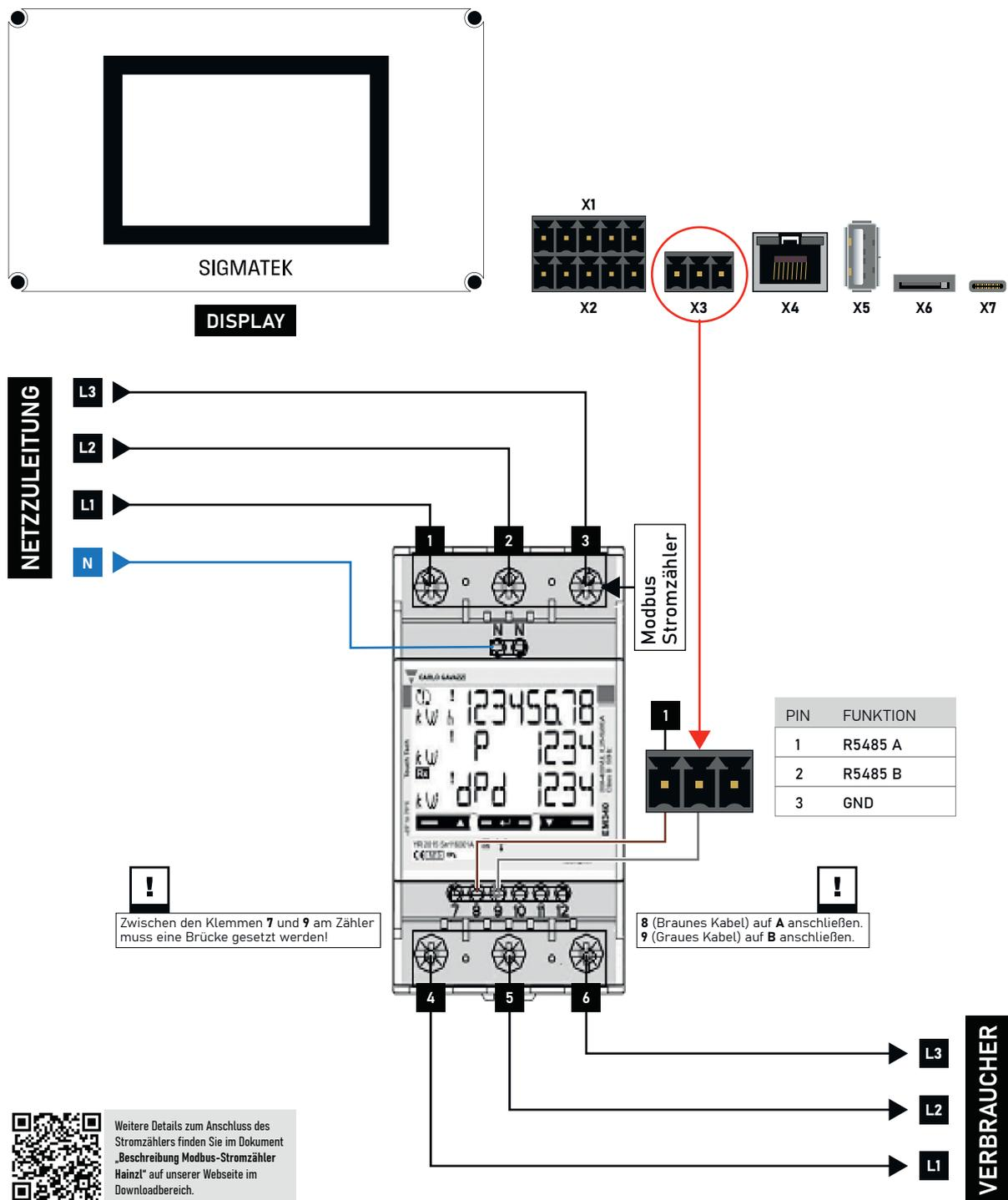
Abb. 9: Einbindung Smart Meter
