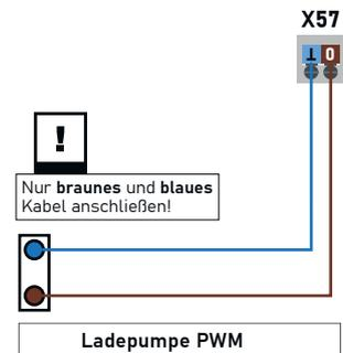
Abb. 6: Anschluss Hydraulikstation
