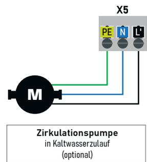
Abb. 8: Anschluss Frischwassersystem
