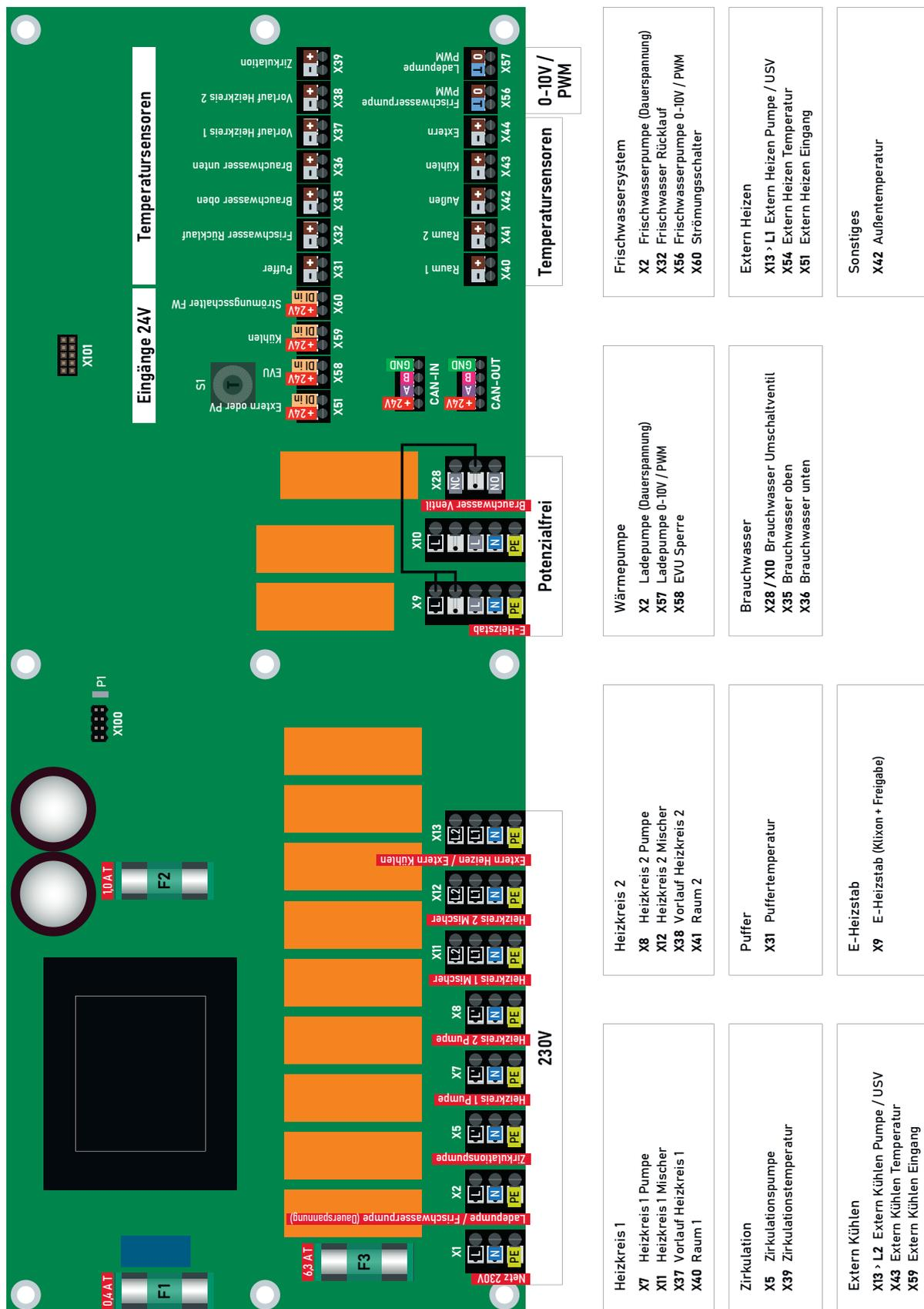
Abb. 3: Anschlussklemmen AHC Hydraulikregler
