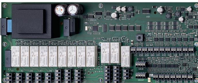
Abb. 2: AHC-Hydraulikregleinheit 180x135x50mm
