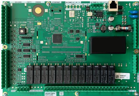
Abb. 2: AHC-Hydraulikregeleinheit 310x170x80mm
