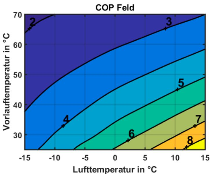
Abb. 31: EU15L bei 11kW Heizleistung
