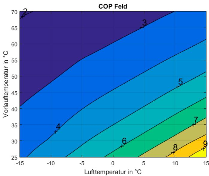
Abb. 33: EU20L bei 14kW Heizleistung
