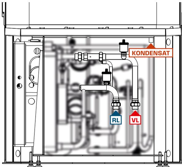
Abb. 13: Hydraulik anschließen
