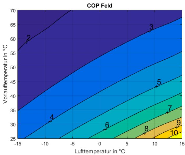
Abb. 27: EU10L bei 6kW Heizleistung
