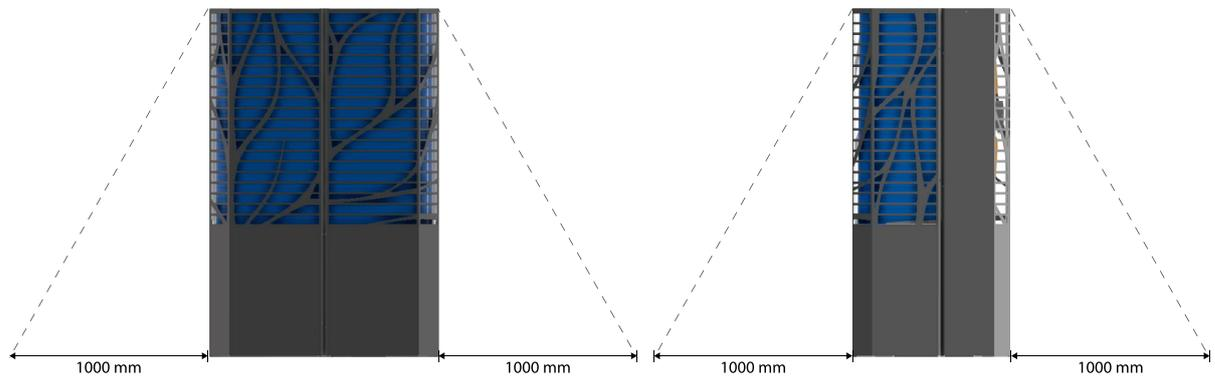
Abb. 8: Schutzzonen (1m Abstand zur Gehäusefläche / kegelförmig)
