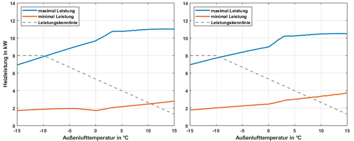
Abb. 24: Leistungsbereich der EU08L je nach Außenlufttemperatur bei 5K Spreizung und 85 % Luftfeuchte (links: 35 °C Vorlauftemperatur / rechts: 55 °C Vorlauftemperatur) mit empfohlener Leistungskennlinie nach EN 14825.
