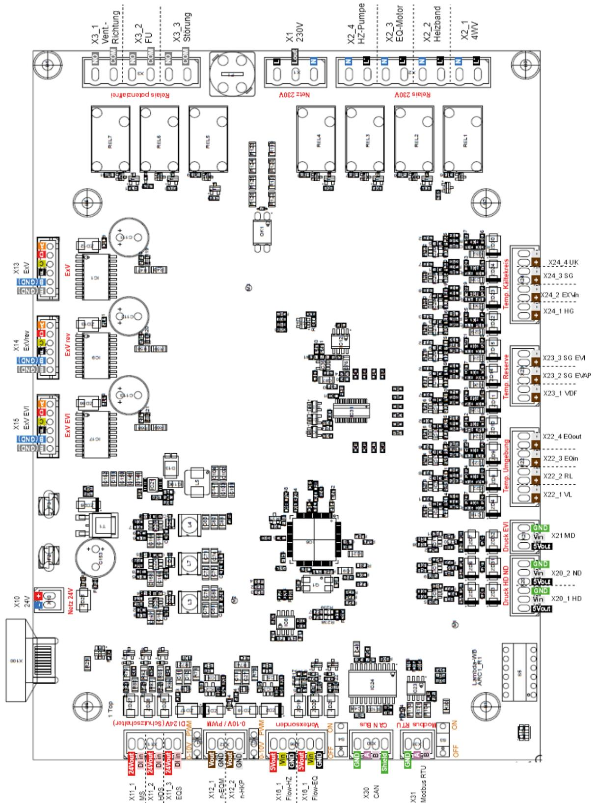
Abb. 17: Anschlussklemmen ARC Kältekreisregler
