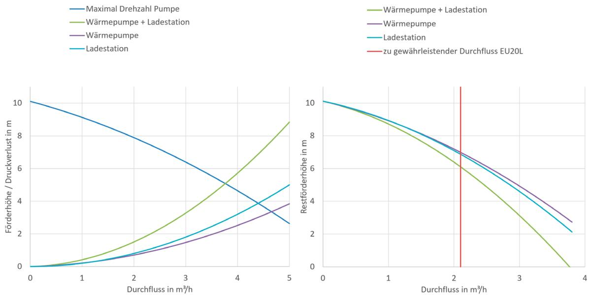
Abb. 35: Pumpenkennlinie, Anlagenkennlinie und Restförderhöhe EU20L
