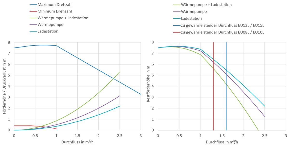
Abb. 34: Pumpenkennlinie, Anlagenkennlinie und Restförderhöhe EU08L, EU10L, EU13L, EU15L
