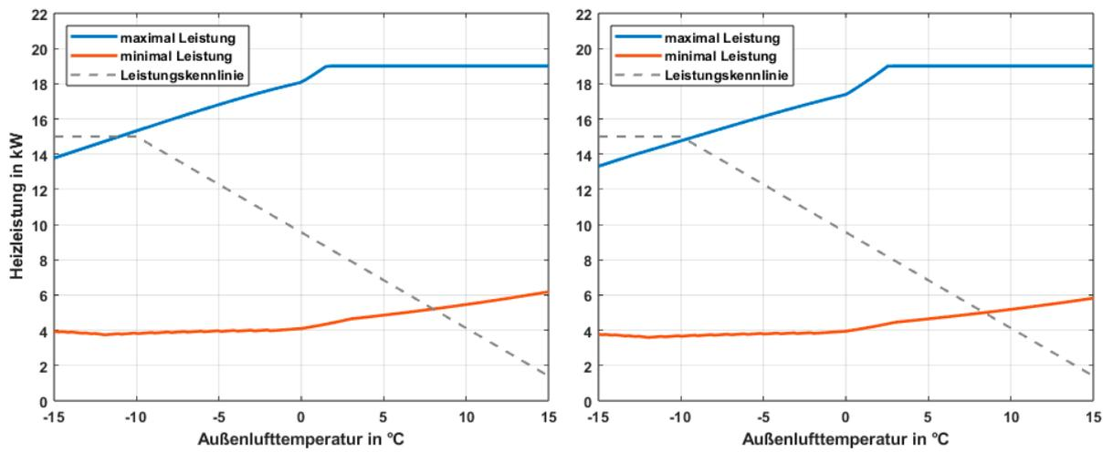
Abb. 30: Leistungsbereich der EU15L je nach Außenlufttemperatur bei 5K Spreizung und 85% Luftfeuchte (links: 35 °C Vorlauftemperatur / rechts: 55 °C Vorlauftemperatur) mit empfohlener Leistungskennlinie nach EN 14825.
