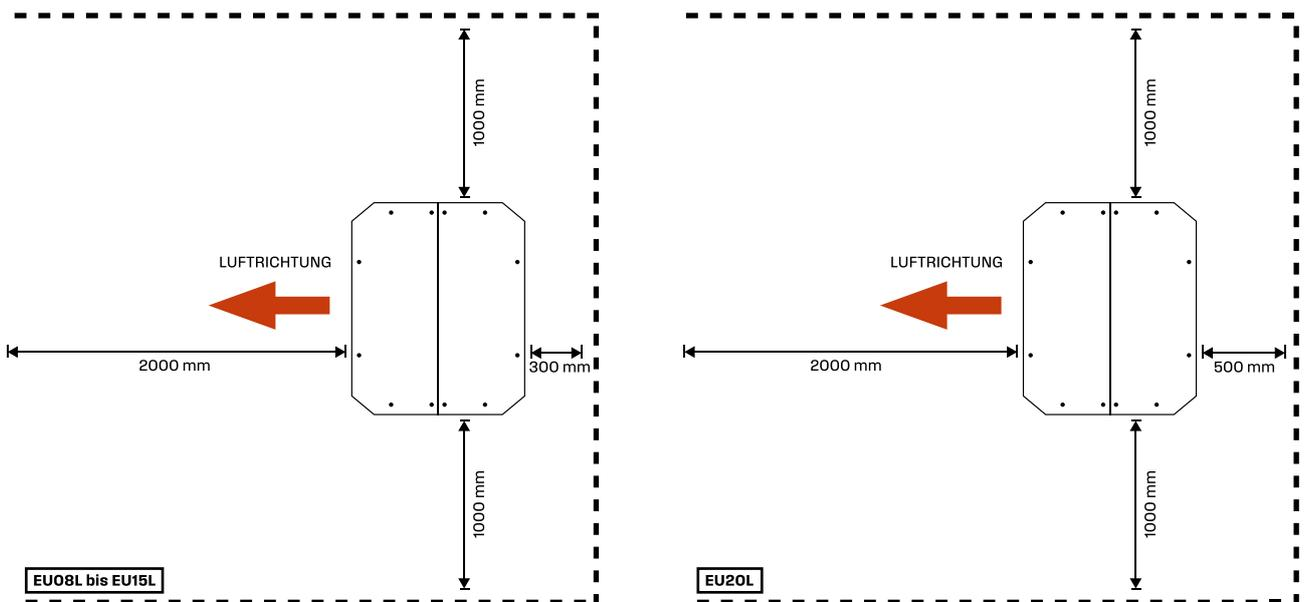
Abb. 9: Mindestabstände (EU08L bis EU15L 300 mm bzw. EU20L 500 mm Mindestabstand zur Wand)
