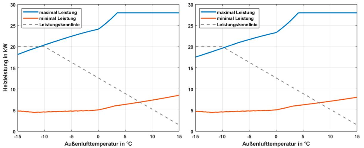
Abb. 32: Leistungsbereich der EU20L je nach Außenlufttemperatur bei 5K Spreizung und 85 % Luftfeuchte (links: 35 °C Vorlauftemperatur / rechts: 55 °C Vorlauftemperatur) mit empfohlener Leistungskennlinie nach EN 14825.
