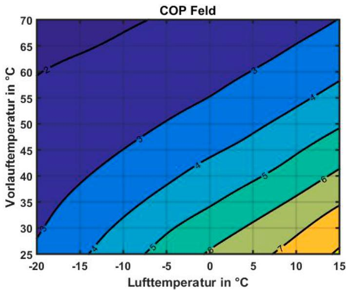
Abb. 25: EU08L bei 6kW Heizleistung
