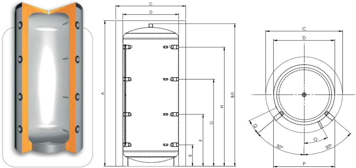
Kurzbeschreibung: 500l Heizwasserspeicher ohne Wärmetauscher und Schichttrennblech.
