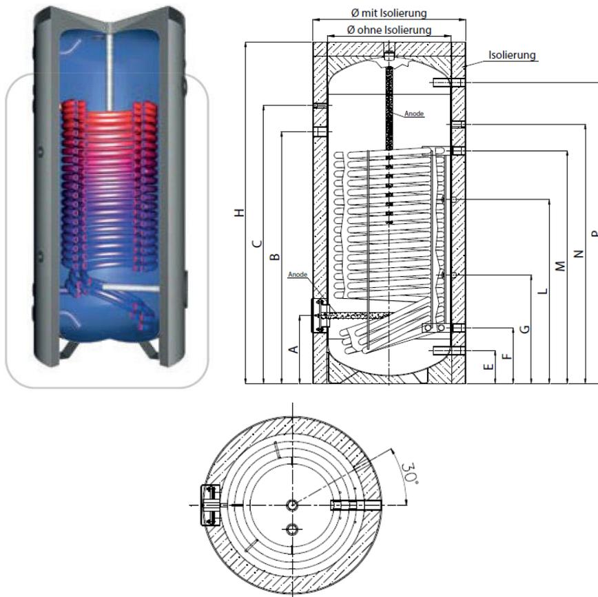
Kurzbeschreibung: 300l emaillierter Warmwasserspeicher mit Glattrohrregister. Isolierung nicht abnehmbar.
