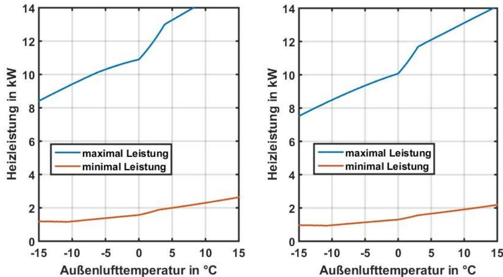
Abbildung 32: EU10L bei 5K Spreizung (links: 35°C Vorlauftemperatur / rechts: 55°C Vorlauftemperatur)
