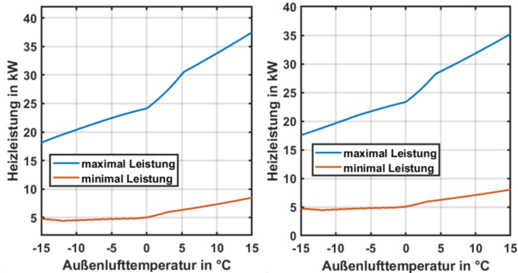
Abbildung 41: EU20L bei 5K Spreizung (links: 35°C Vorlauftemperatur / rechts: 55°C Vorlauftemperatur)
