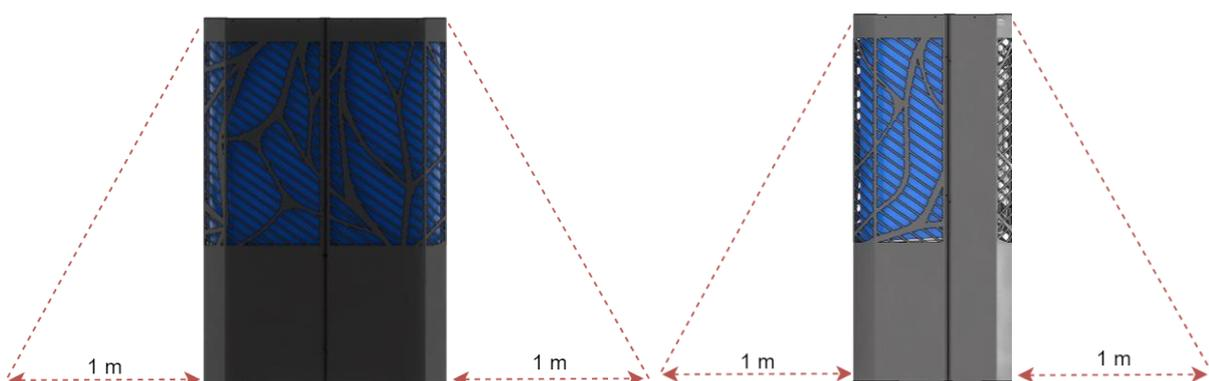
Abbildung 11: Schutzzonen (1m Abstand zur Gehäusefläche / kegelförmig)
