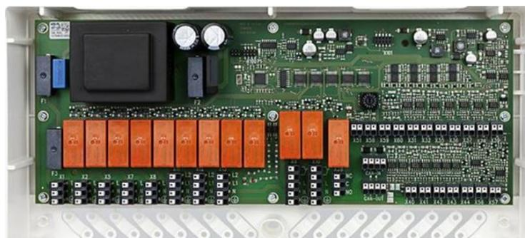
Abbildung 10: AHC-Hydraulikregleinheit 310x170x80mm
