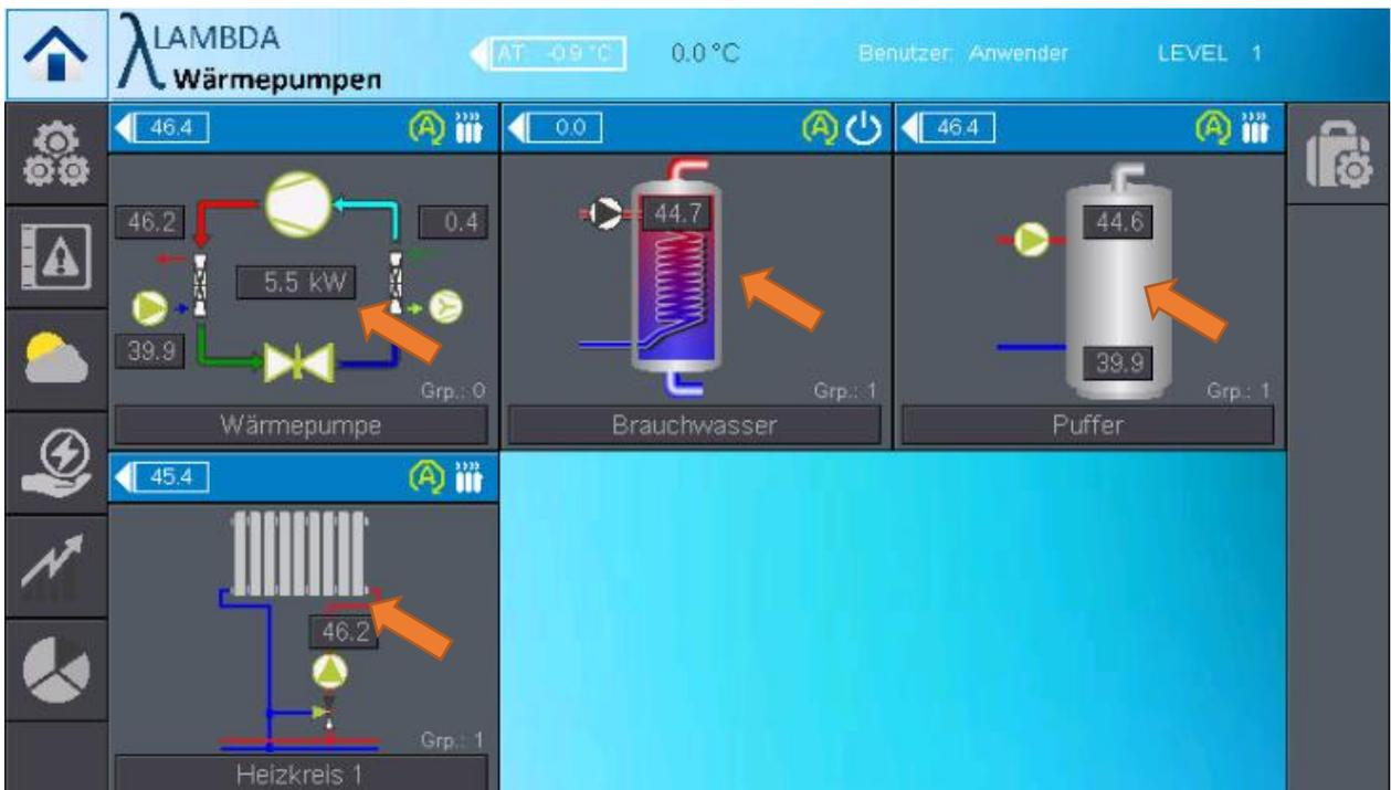
9) Im Anschluss führen Sie noch einen Relaiertest
