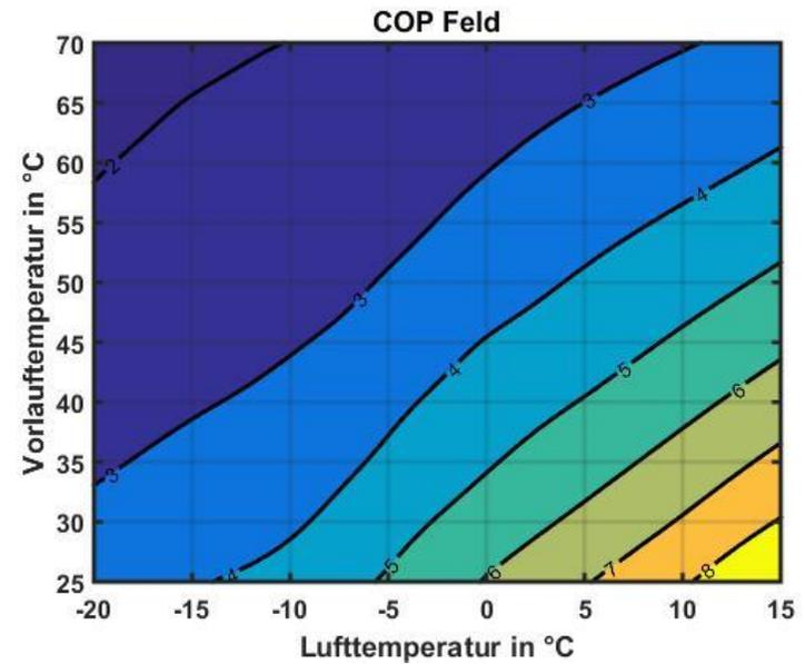
Abbildung 36: EU13L bei 9kW Heizleistung
