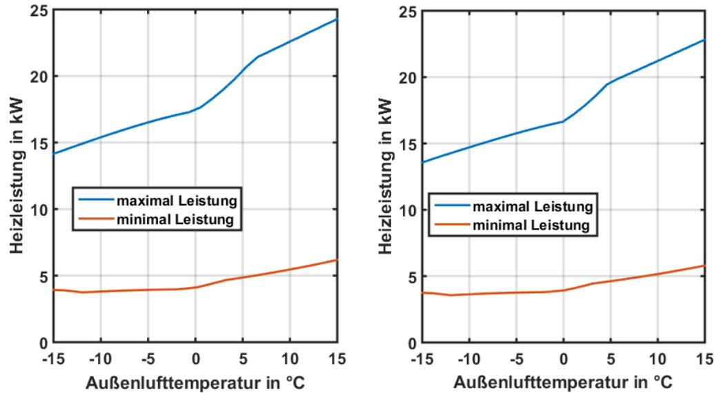
Abbildung 38: EU15L bei 5K Spreizung (links: 35°C Vorlauftemperatur / rechts: 55°C Vorlauftemperatur)
