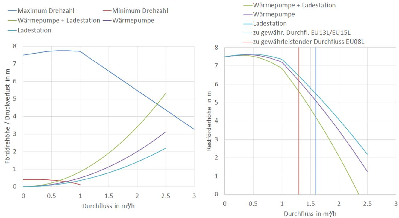
Abbildung 44: Pumpenkennlinie, Anlagenkennlinie und Restförderhöhe EU08L, EU10L, EU13L, EU15L
