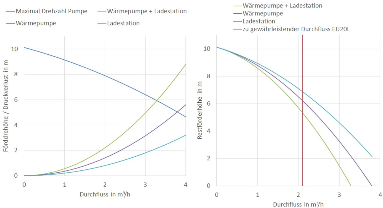
Abbildung 45: Pumpenkennlinie, Anlagenkennlinie und Restförderhöhe EU20L
