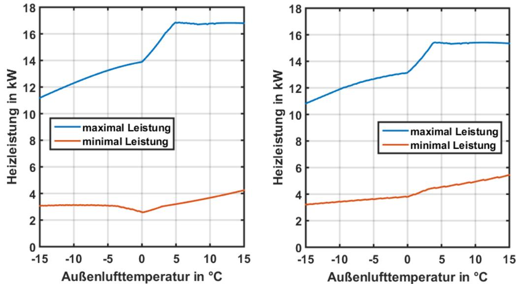
Abbildung 35: EU13L bei 5K Spreizung (links: 35°C Vorlauftemperatur / rechts: 55°C Vorlauftemperatur)
