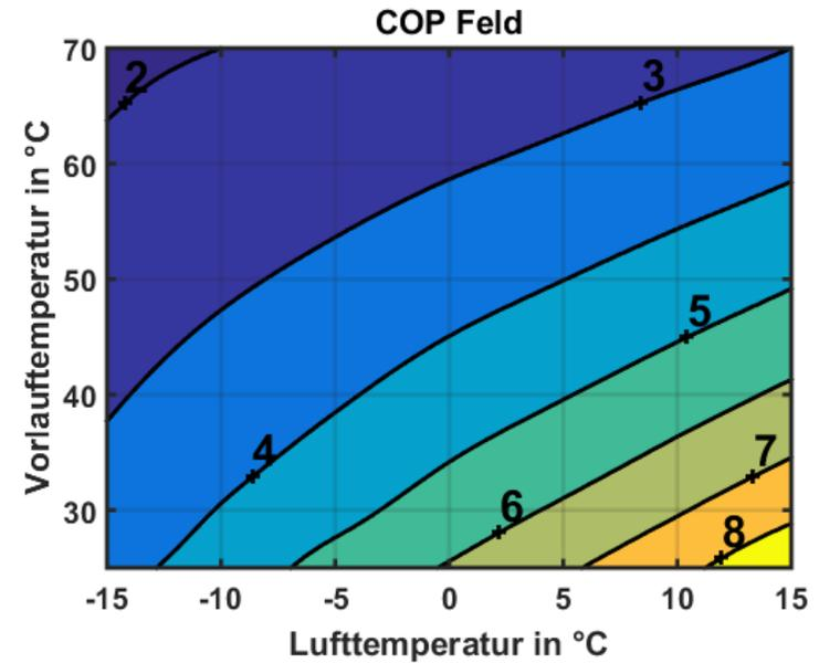
Abbildung 39: EU15L bei 11kW Heizleistung
