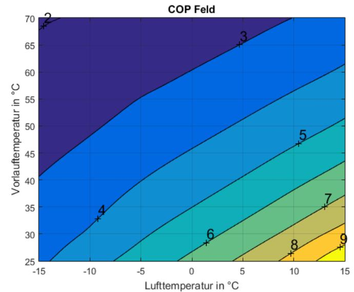
Abbildung 42: EU20L bei 14kW Heizleistung
