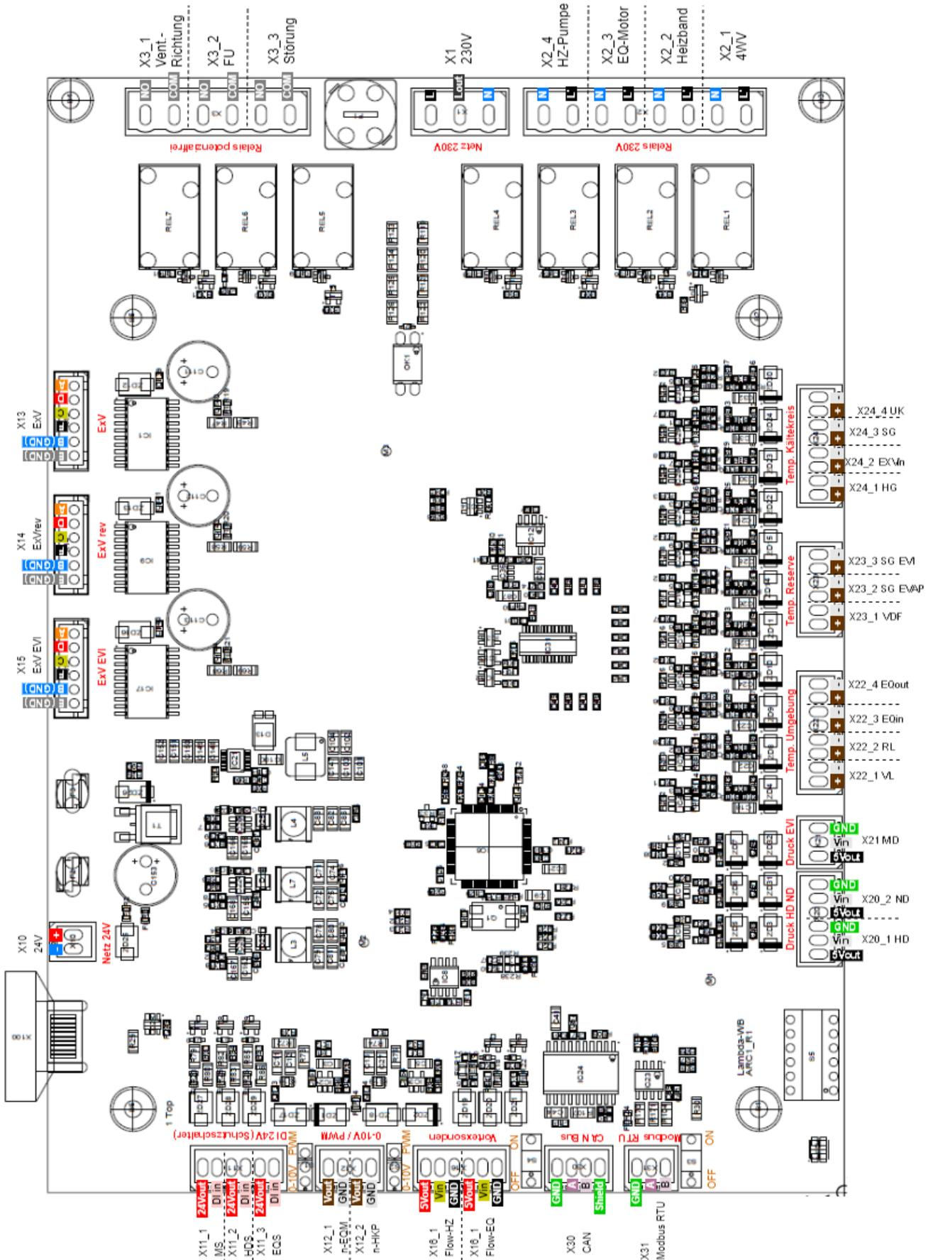
Abbildung 20: Anschlussklemmen ARC Kältekreisregler
