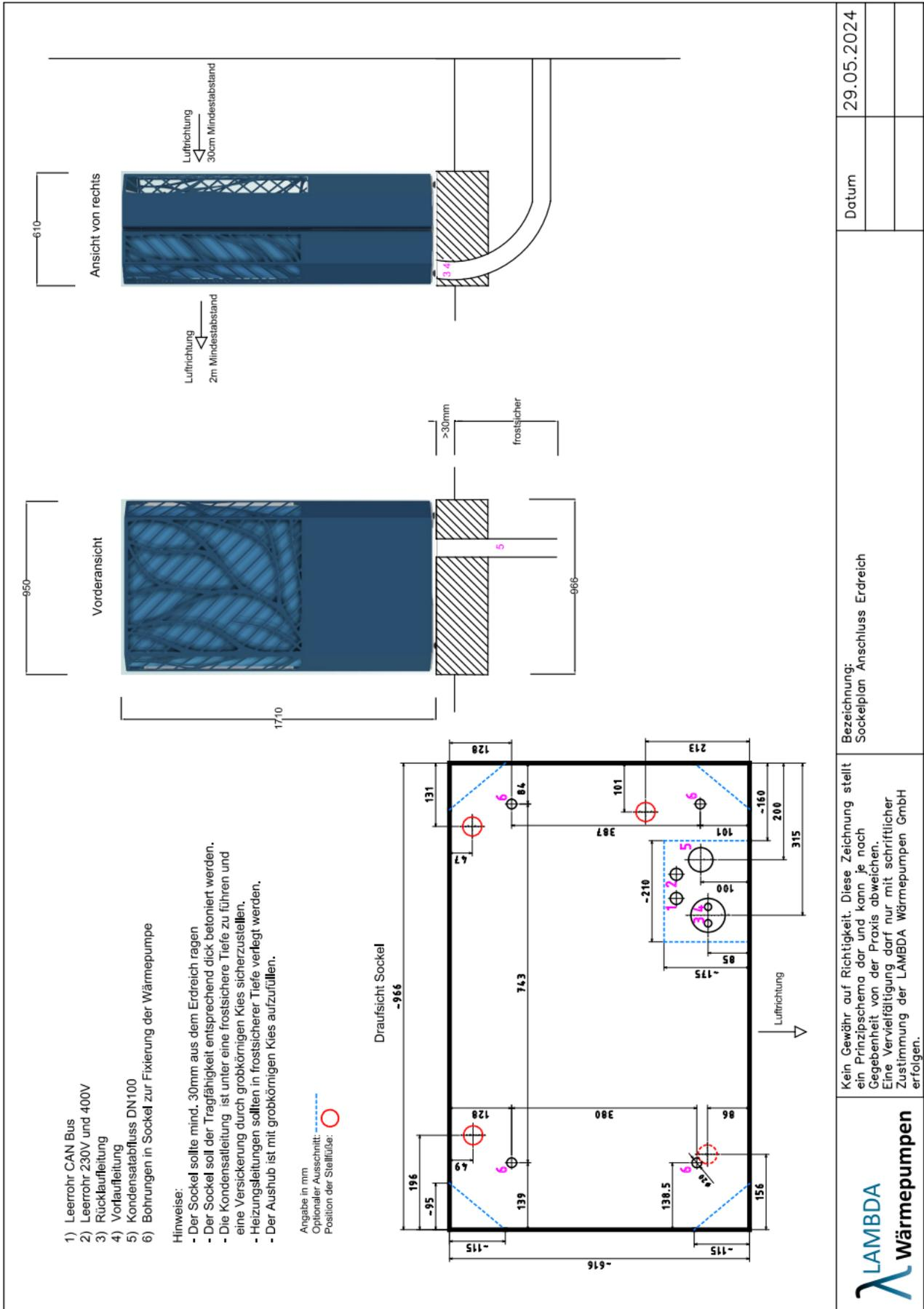
Abbildung 13: Sockelplan Prinzipschema EU08L, EU10L, EU13L und EU15L
