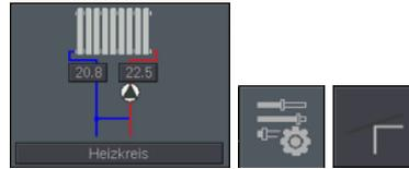
Die Heizkurve definiert die Abhängigkeit der (Vorlauf)-Solltemperatur des Heizkreises zur Außentemperatur. Je geringer die Außentemperatur desto höhere Heizwassertemperaturen werden benötigt, um das Gebäude zu beheizen.
