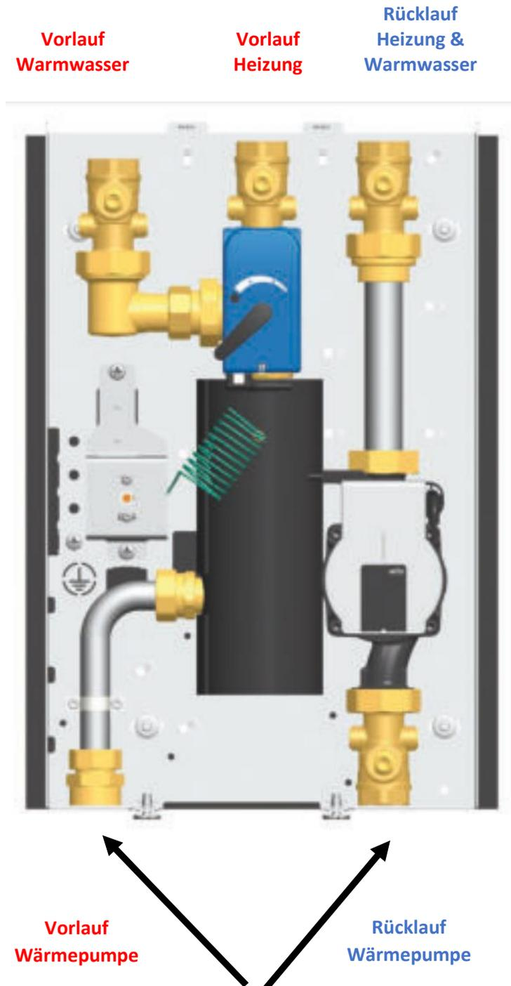
**Kugelhähne sind standardmäßig bei Auslieferung geschlossen. Bei Frostgefahr Wärmepumpe erst am Tag der Inbetriebnahme füllen!**
