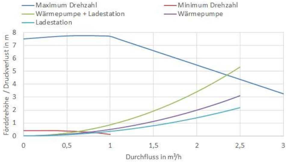
Abbildung 39: Pumpenkennlinie Grundfoss UPM3L 75/180 und Anlagenkennlinie
