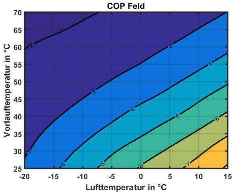
Abbildung 35: EU08L bei 6kW Heizleistung
