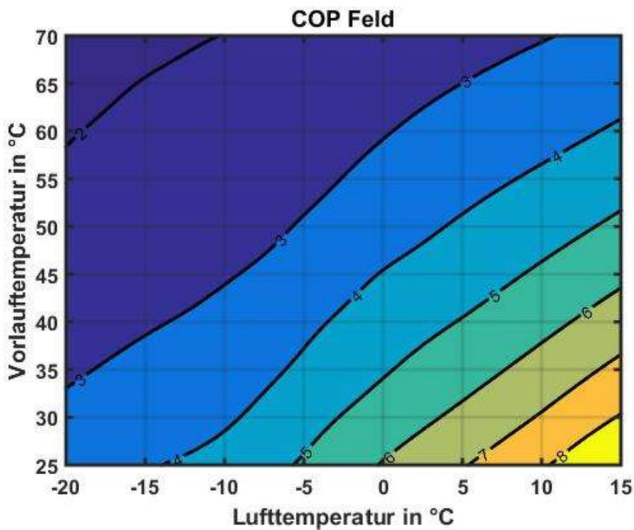
Abbildung 34: EU13L bei 9kW Heizleistung
